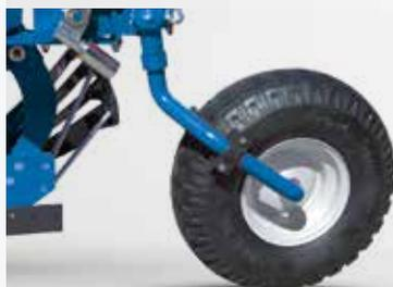
**Roue de contrôle pneumatique**
